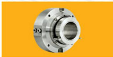
مکانیکال سیل های کارتريج بصورت پیش نصب طراحی می شوند ، گلند و متعلقات دیگر روی یک اسلیو نصب میشوند و کل مجموعه باهم روی پمپ نصب می گردد و دیگر نیازی به تنظیم قطعات ندارد ولی در مکانیکال سیل های نوع غیر کارتريج، قطعات بصورت مجزا روی پمپ نصب می شوند و در حین نصب نیاز به تنظیم دارند. از دیگر ویژگی های این مکانیکال سیل ها می توان به اتفاق گرمای خوب و طول عمر بالا اشاره کرد. این مکانیکال سیل ها در صنایع شیمیایی، صنایع دارویی، صنایع غذا و آشامیدنی، صنایع نفت و گاز و غیره کاربرد دارد.
