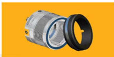
مکانیکال سیل های متال بلوز تحت لحیم کاری، جوش کاری شده است و بصورت سری بر روی هم، دیافرگمی را تشکیل میدهد که حالت انعطاف پذیری داشته که از سایش بیشتر فیس جلوگیری میکند. این گونه آبندها بیشتر در درجه حرارت بالا و در صنایع مختلفی مانند مواد شیمیایی خورنده، نفت، پالایشگاه و صنعت پلیمر و غیره مورد استفاده قرار می گیرد. این نوع مکانیکال سیل از نوع بالانس می باشد.
